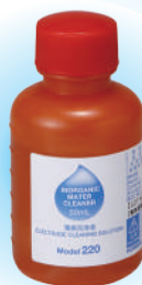
Solución de limpieza 220 (Part no. 3014028653) - contiene 10% de Thiourea y 1% de ácido hidrocórico (HCl) para eliminar los residuos inorgánicos sobre la membrana del sensor y el punto de unión .
