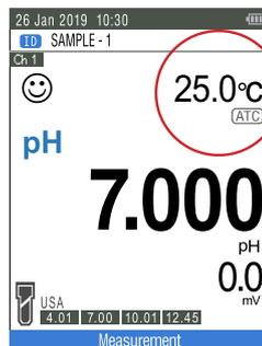
El sensor de temperatura está conectado al medidor
