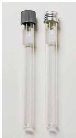
Para el cultivo, transporte y almacenamiento. Pared robusta, espesor 1,1 mm. Boca ancha para una fácil inoculación y limpieza. Completos con tapón de rosca de aluminio o plástico y junta de goma. Autoclavables.
