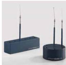
**Asas de inoculación** a base de acero inoxidable, cable especial de acero inoxidable o alambre de platino iridio (90/10). Se pueden calentar al rojo vivo. Longitud: 60 mm. Diámetro del alambre: 0,5 mm.
