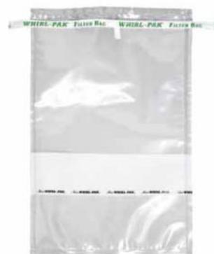
Estas bolsas especiales contienen una tercera capa de polietileno finamente perforado, que filtra los sólidos de la muestra cuando se utiliza en un mezclador homogeneizador. Esto permite un fácil pipeteo de la muestra. El diámetro del agujero en la capa de filtro mide 0,33 mm y hay 285 agujeros por cm<sup>2</sup>. Con etiqueta de escritura. Rango de temperatura: -210 a 82 °C.
