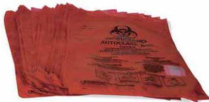
Para recoger las puntas de las pipetas y los tubos de microcentrífuga.
