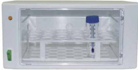
La Mini-Incubadora CULTURA® M ha sido diseñada específicamente para la incubación, tanto de láminas de cultivo como de placas Petri, para la detección de bacterias, hongos y levaduras. Gracias a su pequeño tamaño puede ser transportada a cualquier lugar donde necesite ser utilizada. La incubadora CULTURA® M tiene una capacidad interna de aproximadamente 4 l. Se utiliza en el diagnóstico médico y en el análisis de aguas residuales.
