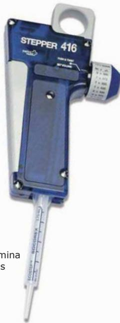
Pipeta muy cómoda, destinada a una repetición fiable de la dispensación de 10 a 5000 µl. El exclusivo mecanismo de acción del gatillo elimina la fatiga del pulgar. Los materiales seleccionados aseguran la fiabilidad en el uso, día tras día. Su forma compacta limita en gran medida la contaminación interna del instrumento. Amplia selección entre 53 volúmenes diferentes; hasta 73 dosis por llenado. Dos años de garantía.
