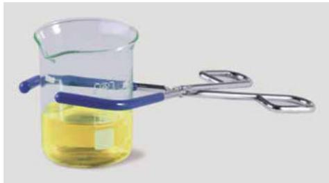
Las mordazas aisladas recubiertas de PVC sirven para sujetar todo tipo de vasos de precipitados de hasta 1000 ml.
