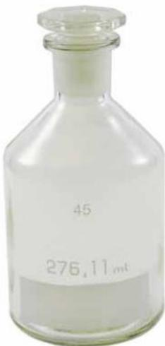
Para la determinación del oxígeno disuelto en el agua. La capacidad medida se especifica en  $\pm 0,01$  ml. Con área de etiquetado blanco. Tapón de vidrio sólido, biselado, asegurado con un clip de resorte accesorio. Cada botella se ajusta al tapón correspondiente. Por lo tanto, los tapones y las botellas no son intercambiables. Cada botella y su tapón están marcados con un número de identificación único y coincidente.
