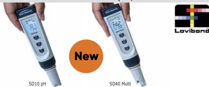
**SD10 pH:** Tester de bolsillo con carcasa estanca para medir pH, mV y temperatura. Ideal para comprobaciones periódicas en plantas industriales o piscinas. Con cordón y clip en la cabeza del aparato.
