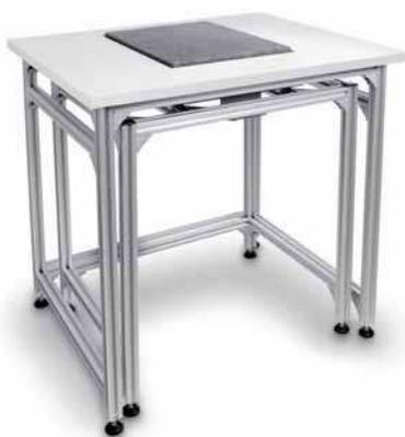
Diseñada para absorber golpes y vibraciones que, de lo contrario, falsearían el resultado de la pesada. Con un plato de piedra de granito apoyado sobre elementos de caucho, que sirve de superficie de apoyo para una balanza analítica. La encimera encierra el plato de piedra y ofrece numerosas posibilidades de almacenamiento.
