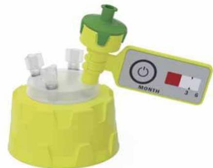
Tapones roscados, con inserto libremente desplazable, de PP, con rosca hembra UNF 1/4" 28G, para la conexión de tubos capilares (D.E. 3,2 mm) y una válvula de aire b.safe. Sin polihaloolefinas.
