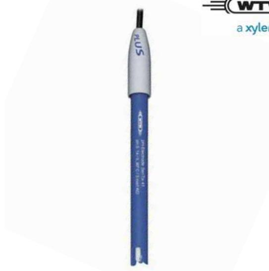
Electrodos combinados básicos de pH, con cuerpo de plástico, sistema de referencia de gel. Sentix 21-3 y Sentix 41-3 con cable fijo de 3 m.
