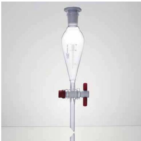
Embudo de separación según Squibb con llave de paso de PTFE.
