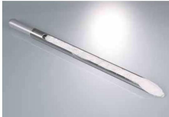
Muestreador universal de polvo y gránulos de acero inoxidable AISI 316. Desarrollado especialmente para muestras de leche en polvo, cumple con las normas de la DIN y la FIL (Federación Internacional de Lechería). El colector se inserta en bolsas o barriles y la muestra se extrae con una lanza de perfil semicircular. Se puede esterilizar en autoclave.
